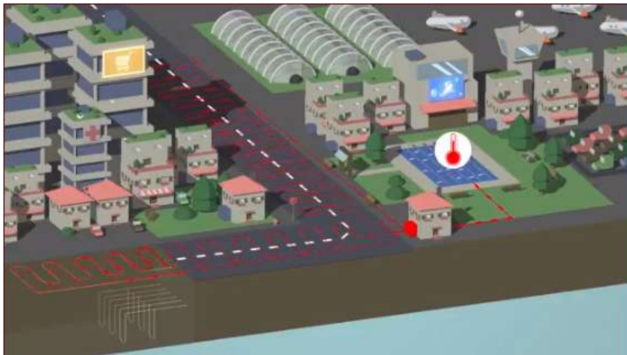
FIGURE II.3: Chauffage avec Power Road[7]
